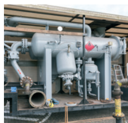
Mobiler Filter DP 70 Vn = bis zu 20.000 m 3 /h
